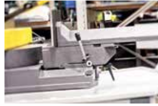
Razendsnel materiaal klemmen middels "speciaal" snelspanstelsysteem
