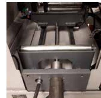
verplaatsing transportklem over lineairgeleiding
