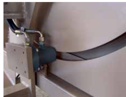
hydraulische klemming zaagraam
