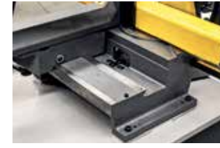
Prisma geleiding van de materiaalklem
