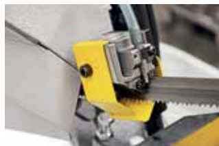
verplaatsing transportklem over lineair geleiders
