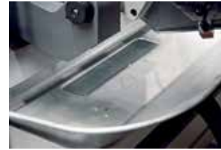
Ruime spanen-/koelwater-opvangbak; voorkomt vervuiling in de werkplaats
