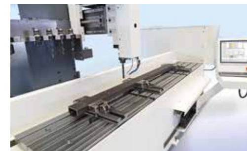
Ruime opspantafel voorzien van T-gleuven
