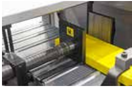
Rollen in het zaagbed
