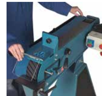
eenvoudig schuurbanden wisselen
