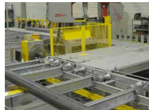
Volautomatisch zaagsysteem geïntegreerd met een optrompmachine
